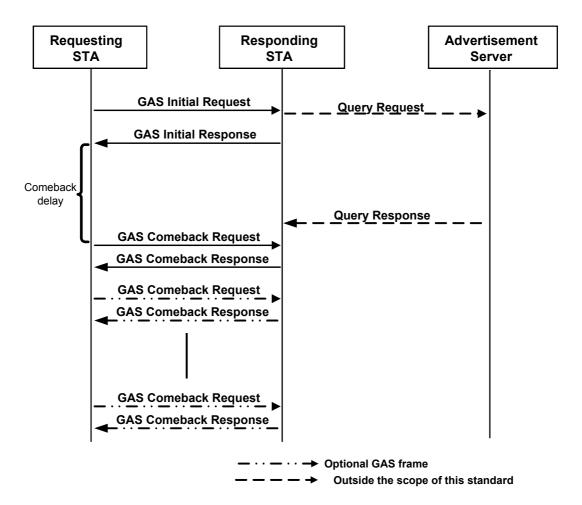
Figure 3: GAS protocol Flow Diagram
