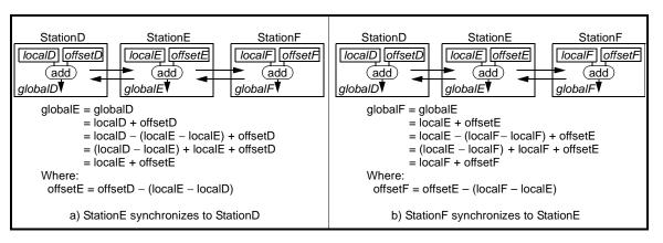
Figure 7.5—Time synchronization principles
