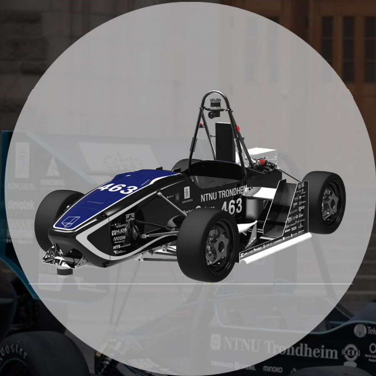
Atmos DV - 2019 139 hk 188,5 kg 64 kanals LiDAR, selvlagd PU
