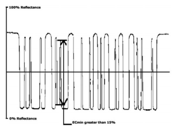
Figure 8 - Passing Minimum Edge Contrast
