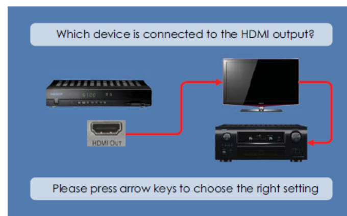
Рис. 5 Корректная обработка громкости в телевизоре, совместимая с Tech 3344 и позволяющая прохождение через телевизор посредством HDMI Audio Return Channel (ARC)
