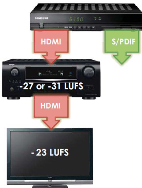
Рис. В-2 AVR подключен к HDMI приставки, ТВ подключен к HDMI AVR
