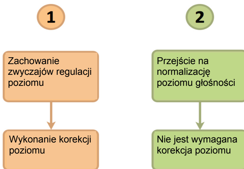
Rysunek 7: Dwie zasadnicze metody pracy zapewniające ujednoczenie głośności w produkcji i post-produkcji
