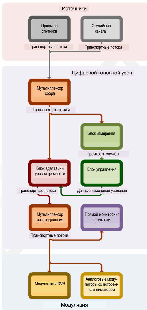
Рис. 3.2.1: Блок-схема цифрового головного узла с интегрированной нормализацией громкости
