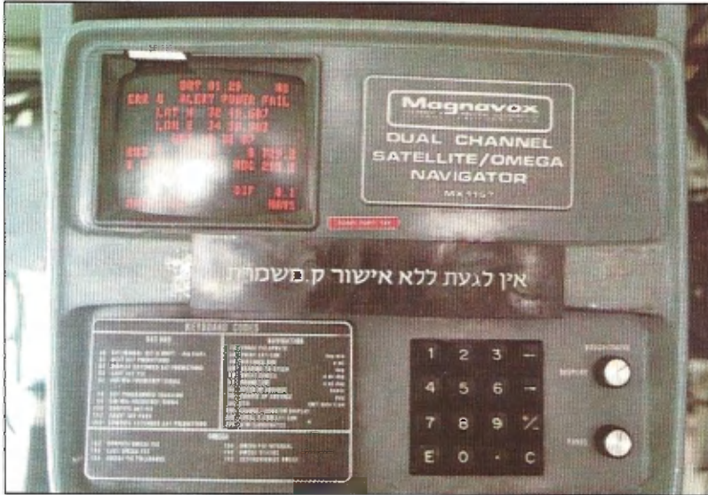
מקלט הלוויינים הוא גם מדוייק מאוד, ואין צורך לאפסו בזווף מדי מספר שעות
