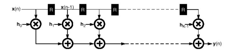
$$y(n) = h_0 x(n) + h_1 x(n-1) + \dots + h_{K-1} x(n-K+1)$$
